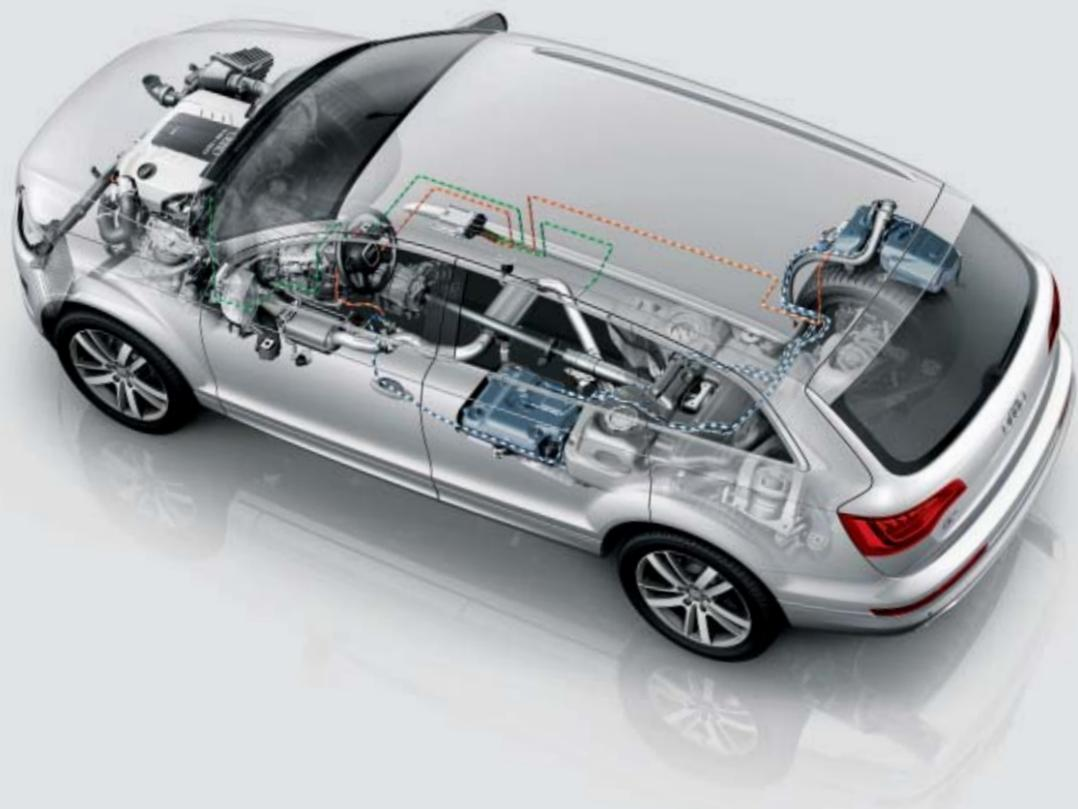
La 3.0 TDI clean diesel quattro è dotata di un catalizzatore per ossido d'azoto con serbatoio AdBlue®. In combinazione con il sistema Common Rail e l'efficientissimo riciclo dei gas di scarico si sono ridotte fino al 90% le emissioni di ossido d'azoto.
