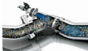
AdBlue® è una soluzione supplementare biodegradabile che viene iniettata in quantità minime all'entrata del catalizzatore per ossido d'azoto.
