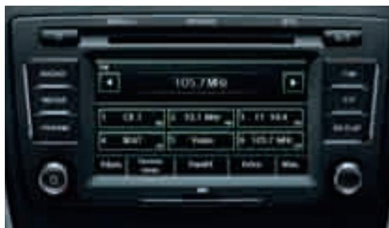
**Radio Bolero:** CD-changer integrato per 6 CD, lettore memory card SD e MMC, lettore CD audio e file audio MP3 o WMA, potenza amplificatore 4x 20 W, processore segnale digitale con equalizzatore, Traffic Information Memory (TIM), possibilità di comando con touch screen a colori 6.5" TFT, display con visualizzazione dati del sistema di climatizzazione Climatronic e dei sensori di parcheggio (1ZO 035 156M)
