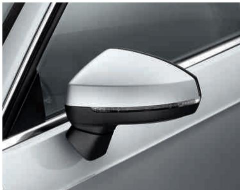
**Specchietti retrovisivi esterni con indicatori di direzione laterali a tecnica a LED integrati,** regolabili elettricamente, alloggiamento nello stesso colore della carrozzeria, specchio sinistro asferico, specchio destro convesso
