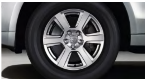
Cerchi in lega di alluminio a 6 razze, 8 J x 17 con pneumatici 235/65 R 17
