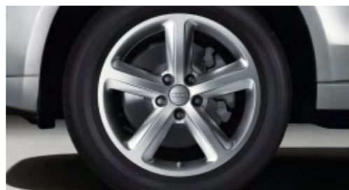
Cerchi in lega di alluminio Audi exclusive a 5 razze, 8 J x 19 con pneumatici 235/55 R 19. Una proposta quattro GmbH
