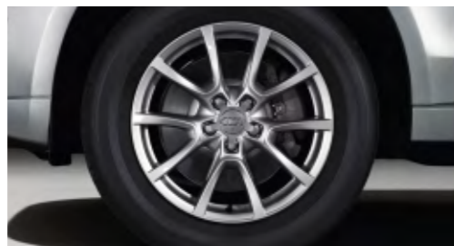
Cerchi in lega di alluminio a 10 razze a V, 8 J x 18 con pneumatici 235/60 R 18
