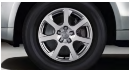
Cerchi in lega di alluminio fucinato a 7 razze, 8 J x 17 con pneumatici 235/65 R 17
