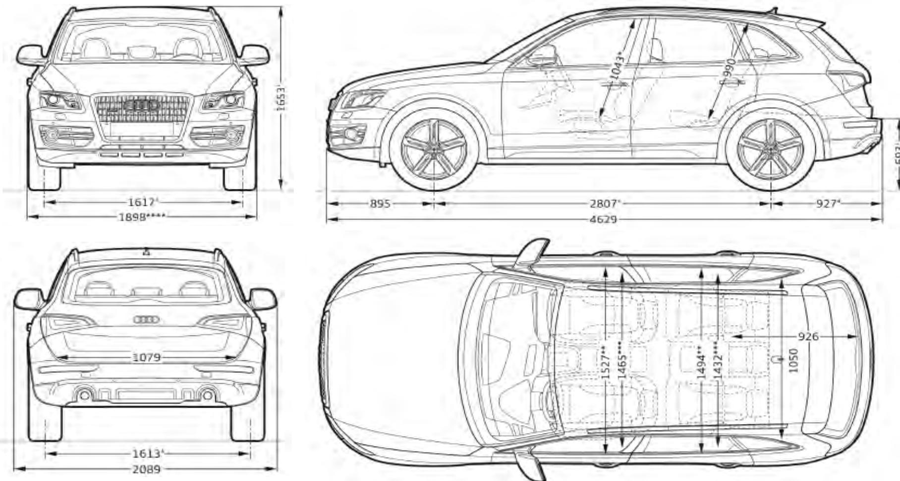
**Misure in millimetri.**
