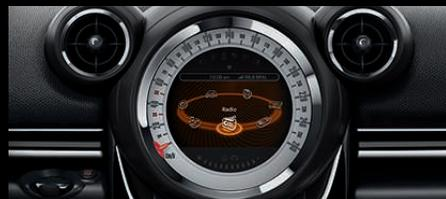
In abbinamento al sistema di navigazione MINI o alla radio MINI Visual Boost, lo strumento rotondo centrale è dotato di un **tachimetro** che circonda il display.
