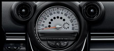
Nel grande **tachimetro** al centro della plancia sono collocate spie di controllo e di avvertimento nonché l'indicatore del livello del carburante.
