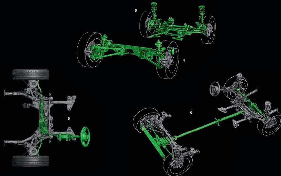
3. ASSALE ANTERIORE A SNODO SINGOLO E MONTANTI MOLLEGGIATI. Due semiassi della stessa lunghezza all'avantreno riducono l'influsso della trazione sullo sterzo, ottimizzando il comportamento della vettura in curva, in accelerazione ed in frenata.
