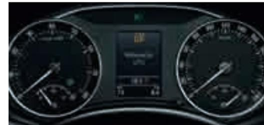
Quando la vettura è alimentata a GPL, la **spia sul cruscotto** è attiva. La quantità di GPL nel serbatoio è chiaramente indicata da una **spia di livello del carburante**. Se l'alimentazione a GPL è ridotta al livello di riserva, viene segnalata in tempo la necessità di rifornirsi di carburante.
