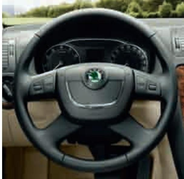
Il **volante multifunzione a 4 razze con rivestimento in pelle** permette di controllare la radio e il telefono. Il **volante multifunzione sportivo a 3 razze con rivestimento in pelle** consente inoltre l'innesto dei rapporti del cambio automatico DSG.
