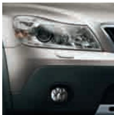
La vettura può essere dotata di **fari allo xeno con moduli orientabili**. Le **luci diurne a LED** (come nella foto) sono integrate nel paraurti anteriore.
