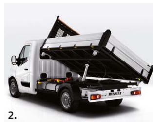
1. Impianto di sollevamento elettroidraulico. 2. Cassone ribaltabile trilaterale
