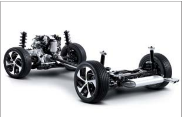
Trazione integrale. Quando si registra una perdita di trazione, fino al 50% della coppia è trasferito alle ruote posteriori per migliorare l'aderenza su ghiaia o superfici scivolose e potenziare la stabilità in curva. In condizioni estreme, la distribuzione della coppia può essere impostata in modalità 50:50 fissa.
