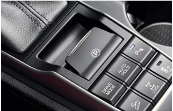
Freno di stazionamento elettrico. Il freno di stazionamento elettronico, grazie alla forma compatta, libera spazio tra i sedili anteriori e si rivela ancor più comodo grazie alla funzione di rilascio automatico.
