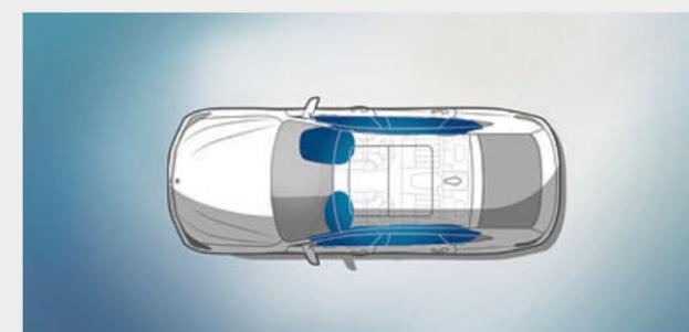
■ Gli **airbag per guidatore e passeggero anteriore** fanno parte del sistema di sicurezza BMW nel quale tutti i componenti sono armonizzati in modo ottimale. Complessivamente sono presenti sei airbag per la massima sicurezza. Sono gli airbag per il guidatore e il passeggero anteriore, gli airbag per la testa per le superfici dei finestrini laterali e gli airbag laterali negli schienali dei sedili anteriori.
