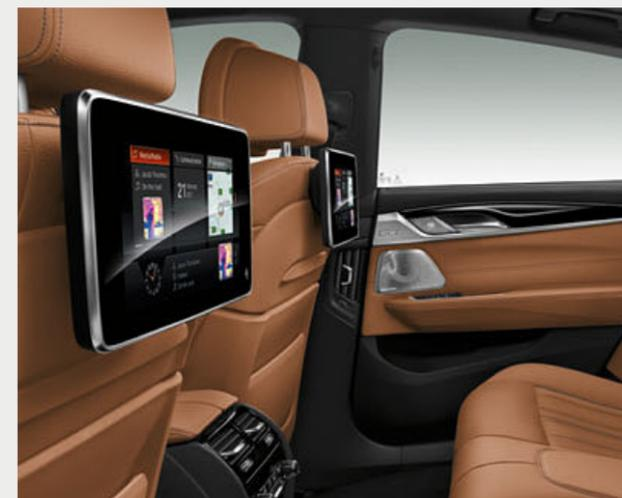
□ Il sistema di intrattenimento per i passeggeri posteriori comprende due display a colori separati da 10,2" a inclinazione regolabile e un lettore Blu-ray. Si può utilizzare per gestire il sistema di navigazione o di infotainment. Il sistema include un telecomando, porte USB e porte per lettori MP3, console per videogiochi e cuffie (anche wireless).
