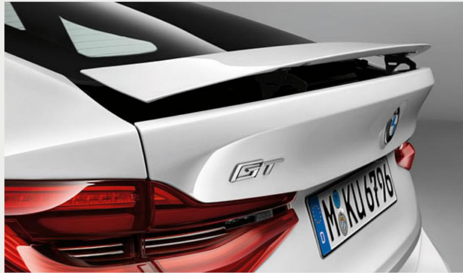
■ A partire da 120 km/h l'Active Spoiler posteriore fuoriesce automaticamente per migliorare la stabilità di marcia e sotto i 70 km/h rientra sempre automaticamente. L'azionamento avviene anche manualmente con un pulsante nella portiera lato guida.
