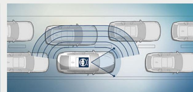
□ **Assistente di mantenimento della corsia con protezione attiva anticollisione laterale**<sup>6</sup>: a velocità da 70 a 210 km/h assiste il guidatore attraverso piccoli interventi sullo sterzo, evitando l'abbandono non intenzionale della corsia di marcia e le collisioni laterali della vettura.
