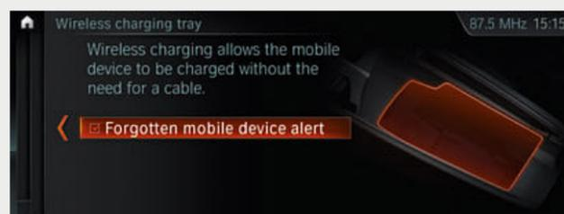
□ La telefonia con ricarica wireless comprende<sup>2</sup> un alloggiamento di ricarica senza fili con prese USB supplementari. La ricezione di radiotelefonata mobile migliora grazie all'utilizzo dell'antenna sul tetto. Attraverso il Bluetooth si possono collegare contemporaneamente due telefoni mobili e un lettore audio. Sono anche disponibili il Bluetooth Office e l'hotspot WLAN.
