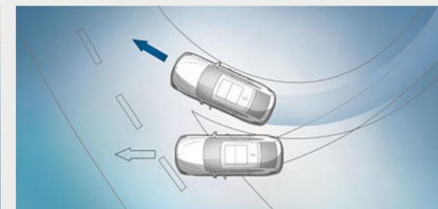
■ Il **Controllo dinamico di stabilità (DSC)** rileva continuamente le condizioni di marcia e, se queste ultime diventano instabili, stabilizza la vettura con la gestione di motore e freni. Altre funzioni del DSC sono ad esempio Asciugatura dei freni, Predisposizione alla frenata o Automatic Hold, che nelle partenze in salita frena la vettura per un breve istante per evitare che arretri.
