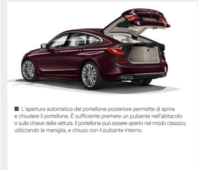
■ L'apertura automatica del portellone posteriore permette di aprire e chiudere il portellone. È sufficiente premere un pulsante nell'abitacolo o sulla chiave della vettura. Il portellone può essere aperto nel modo classico, utilizzando la maniglia, e chiuso con il pulsante interno.
