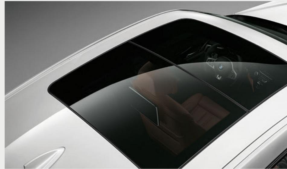
□ Quando è aperto, il tetto panoramico in vetro offre un maggiore flusso di aria esterna all'interno dell'abitacolo. Chiuso, crea un'atmosfera luminosa e piacevole. Si apre e si chiude automaticamente premendo un pulsante o a distanza, è sollevabile e scorrevole ed è dotato di tendina parasole avvolgibile e di deflettore antivento.
