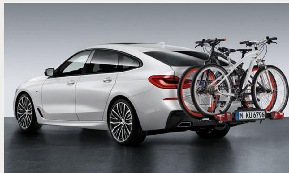
○ Il portabiciclette posteriore Pro 2.0 è leggero, robusto e idoneo a carichi max. di 60 kg. È estremamente facile da utilizzare e può trasportare due biciclette/E-bike (ampliabile a tre biciclette). La sua funzione di ribaltamento permette sempre un accesso facile al vano bagagli.
