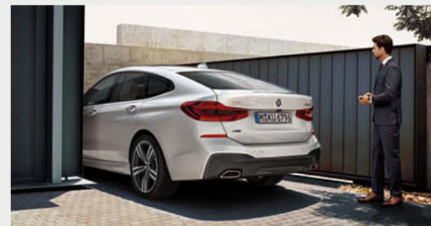
□ La funzione Remote Control Parking<sup>1</sup> consente al guidatore di scendere dall'auto e parcheggiarla mediante telecomando, facendola avanzare in un'area di parcheggio stretta o in un garage e successivamente farla uscire dal parcheggio all'indietro. La funzione Remote Control Parking viene attivata dal guidatore al di fuori della vettura utilizzando la BMW Display Key.
