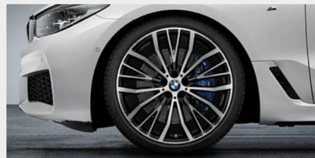
○ I pregiati cerchi in lega leggera da 21" sono realizzati in Black bicolore/lucidati a specchio dalla parte esposta con base laminata e ottimizzata in termini di peso. Set di ruote completo con pneumatici misti Runflat, dimensioni cerchi 8,5J x 21 con pneumatici 245/35 R21 95Y XL RSC ant. e 10J x 21 con pneumatici 275/30 R21 98Y XL RSC post.
