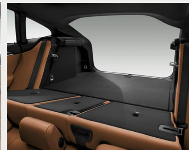
■ Il sistema di carico passante consiste in uno schienale del sedile posteriore divisibile nel rapporto 40:20:40 e garantisce più flessibilità nel trasporto di passeggeri e oggetti. Ad esempio sui sedili posteriori possono stare comodamente seduti due passeggeri e allo stesso tempo è possibile trasportare oggetti lunghi come sci o snowboard.
