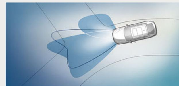
□ L'**Adaptive Light Control**, la distribuzione variabile della luce in città e in autostrada e il BMW Selective Beam offrono un'illuminazione ottimale della carreggiata nelle ore notturne. Già a vettura ferma, quando si accendono gli indicatori di direzione o si ruota il volante, i fari sterzanti integrati si accendono automaticamente e rimangono attivi fino a una velocità di 35 km/h.
