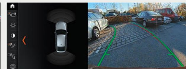
□ La telecamera posteriore migliora inoltre l'orientamento durante la retromarcia a velocità inferiori a 15 km/h, ad esempio nelle manovre di parcheggio. Visualizza sul Control Display la zona dietro la vettura. Le linee interattive misurano la distanza e il diametro di sterzata, assistendo il guidatore nella manovra. Gli ostacoli sono contrassegnati mediante colori.
