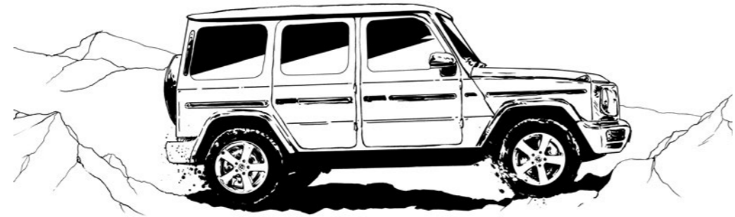
29,9° Angolo di scarpata posteriore
