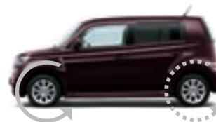
Quando la velocità di rotazione delle ruote anteriori e posteriori è diversa (in curva, sulla neve, su fondi sdruciolevoli) il giunto viscoso trasferisce progressivamente coppia anche all'asse posteriore.
