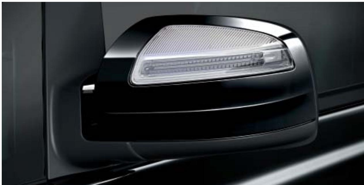
Specchio retrovisore esterno con campo visivo ampliato e indicatore di direzione integrato, a regolazione elettrica
