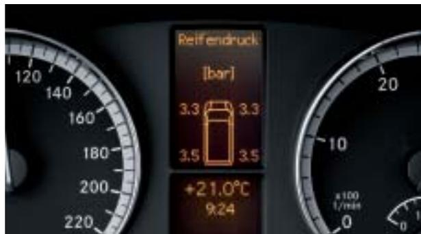
Sistema di controllo automatico della pressione pneumatici
