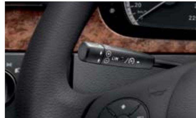
TEMPOMAT con limitatore di velocità variabile (SPEEDTRONIC)
