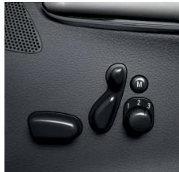
Sedile lato guida e passeggero regolabili elettricamente, con triplice funzione Memory
