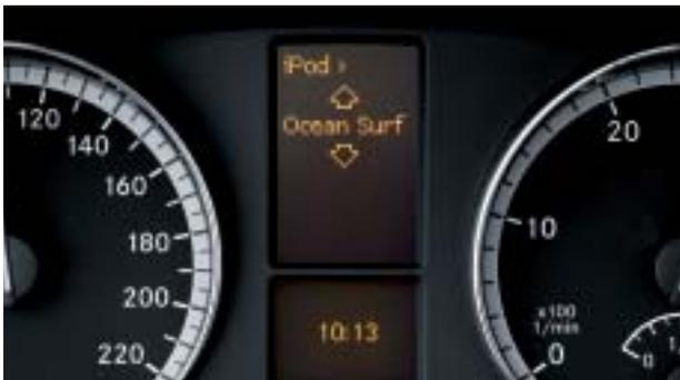
iPod® Interface Kit<sup>2</sup> Mercedes-Benz. Azionate il vostro iPod® comodamente dal volante multifunzione. Potete navigare nei menu, attivare la riproduzione e regolare il volume: il titolo del brano selezionato è visualizzato sulla strumentazione. Protetto dagli sguardi indiscreti, l'iPod® viene collegato e contemporaneamente caricato nel box portaoggetti.
