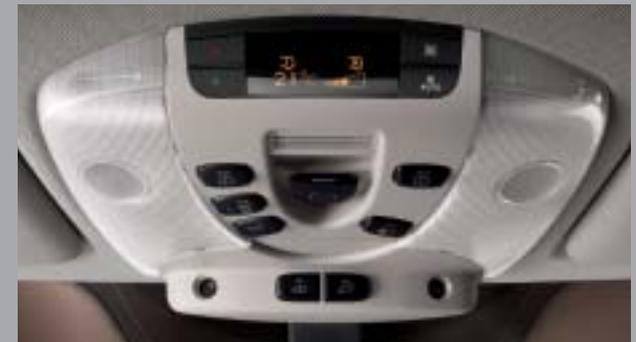
Il gruppo comandi del tetto nel cockpit spicca con superfici lucide e comandi integrati per il riscaldamento e il climatizzatore TEMPOMATIC (di serie) del vano posteriore, che così possono essere azionati dal guidatore.
