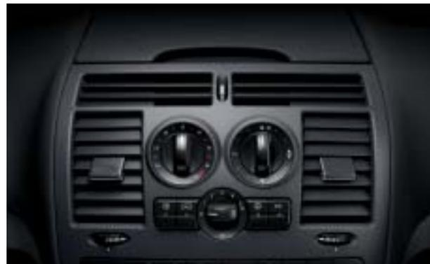
Climatizzatore regolabile elettronico TEMPATIC anteriore e posteriore
