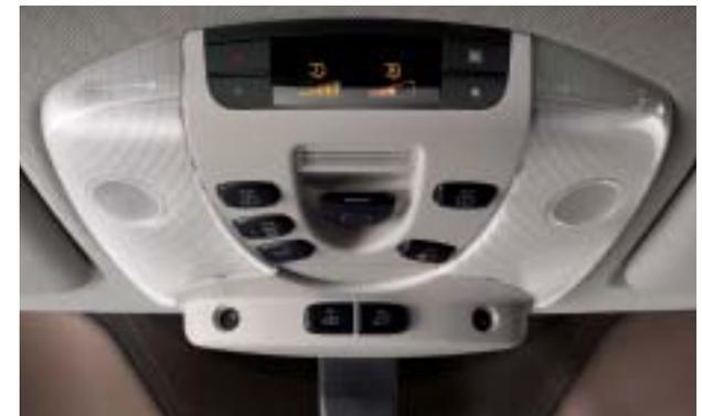
Scambiatore di calore suppl. vano posteriore, comandi separati
