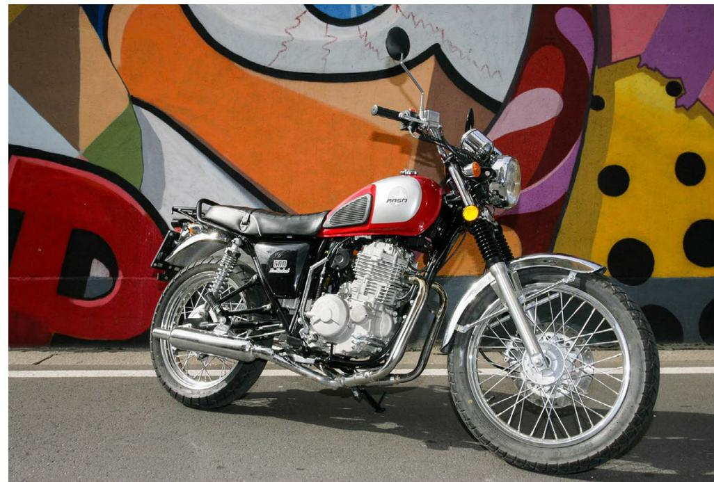
sono diversi da quelli delle altre Mash, in quanto più avvolgenti - è presente solo sugli esemplari di pre-serie, quindi in via di risoluzione. Qui non esiste cavalletto centrale, ma solo la stampella laterale, dotata di interruttore di sicurezza che impedisce l'avviamento del motore anche col cambio in folle: volendo scaldare la moto poggiata sulla stampella, insomma, il motore non si avvierà.
